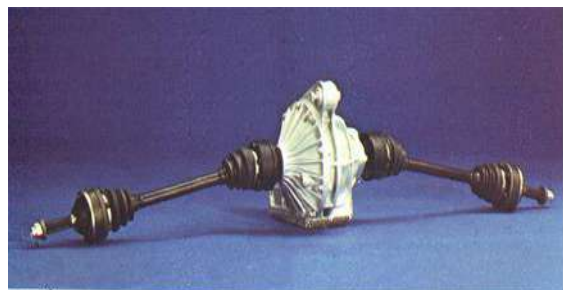
Debajo, el grupo de transmisión trasera del Fiat 124 Abarth con los dos semiejes oscilantes dotados de juntas homocinéticas. Abajo, dos ejemplos característicos de semiejes para vehículos de competición: a la izquierda, el tipo delgado con juntas homocinéticas; a la derecha, el tipo tubular con junta de Cardan y una junta de caucho que actúa también como junta de alargamiento.
